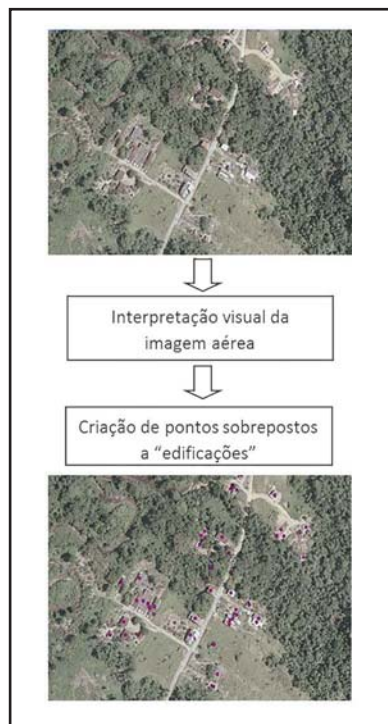
Fotointerpretação de pontos com edificações.
